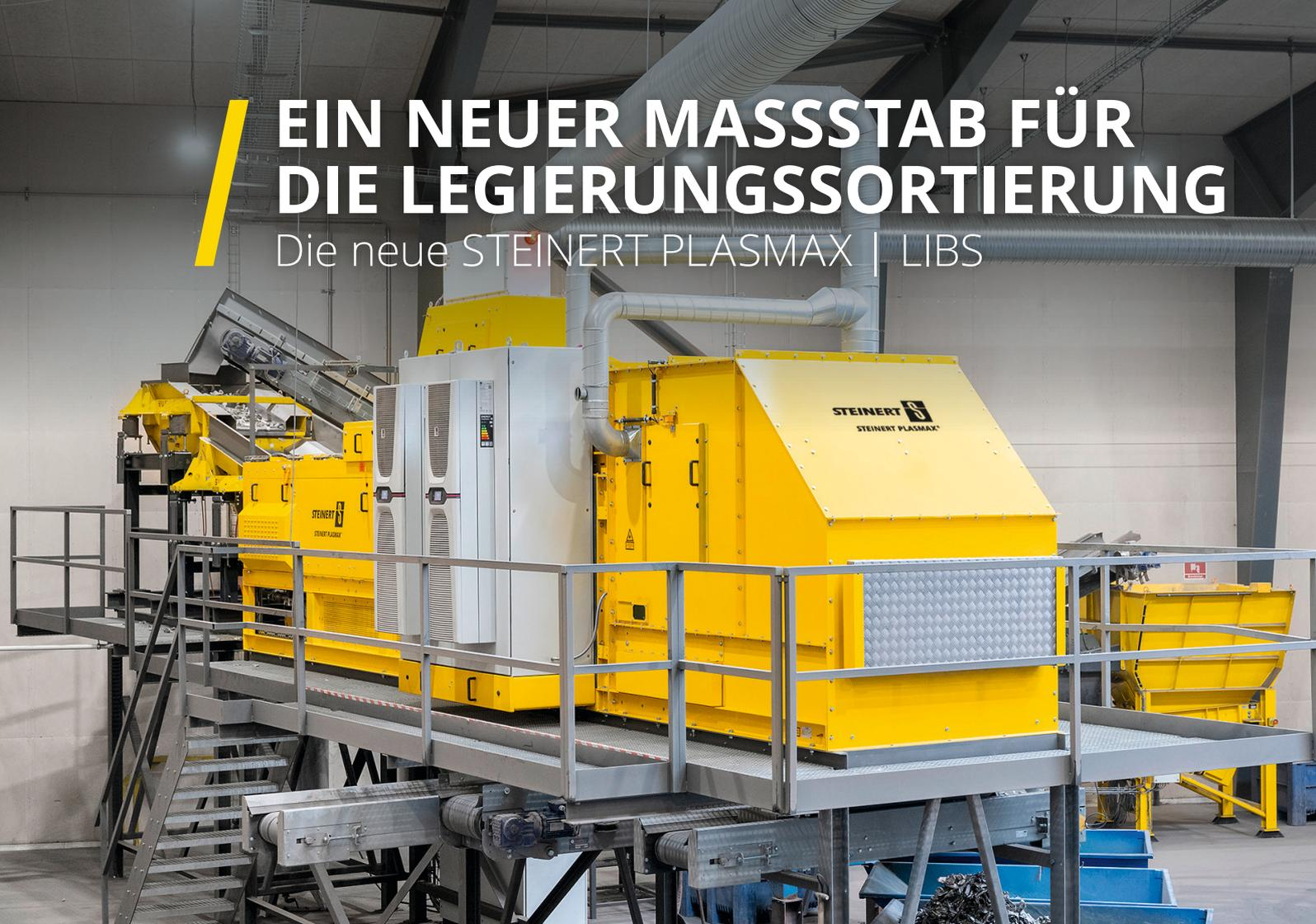
Die neue STEINERT PLASMAX | LIBS ermöglicht Recycling-Betrieben, das Aluminiumrecycling auf die nächste Stufe zu heben und hochwertige Legierungsklassen zielgerichtet und ofenfertig zu produzieren.
